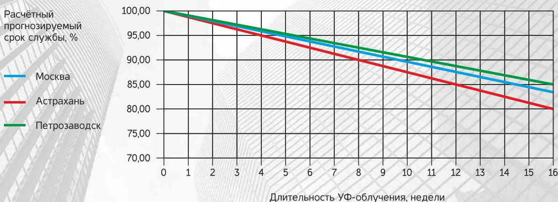
Для сохранения расчётного прогнозируемого срока службы рекомендуется в срок до 7 дней обеспечить защиту ветрозащитной мембраны от воздействия прямого, рассеянного и отражённого УФ-излучения.
